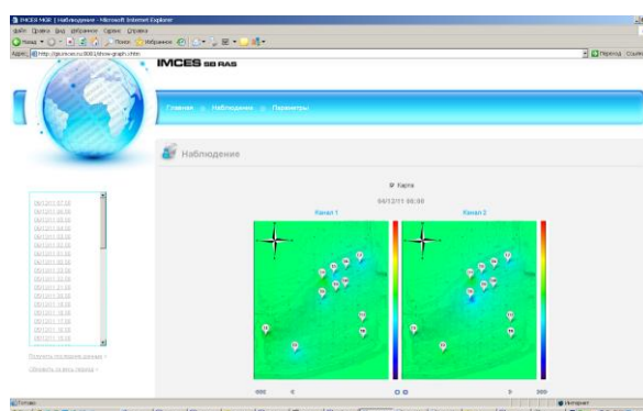
Пример экрана монитора оператора, результатов оценки геодинамики оползневого склона в режиме «светофора».
