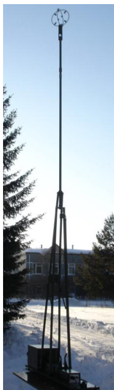
Высота метеомачты в раз- вернутом состоянии 4 м
