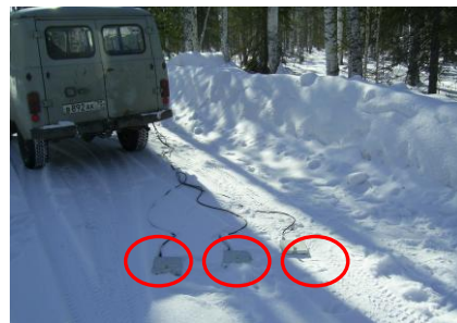
Профильные измерения тремя маршрутными станциями
