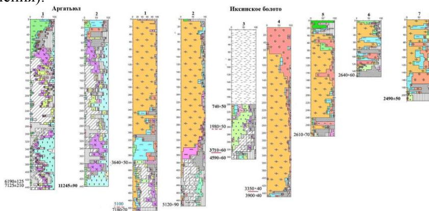
Рис. 65. Стратиграфическая колонка торфяных залежей южнотаежных болот: I – Аргатьюл, II - Иксинское
