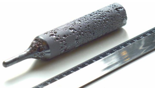
Рис. 38. Монокристалл ZnGeP_2 , выращенный в прецизионно управляемой термической установке для
