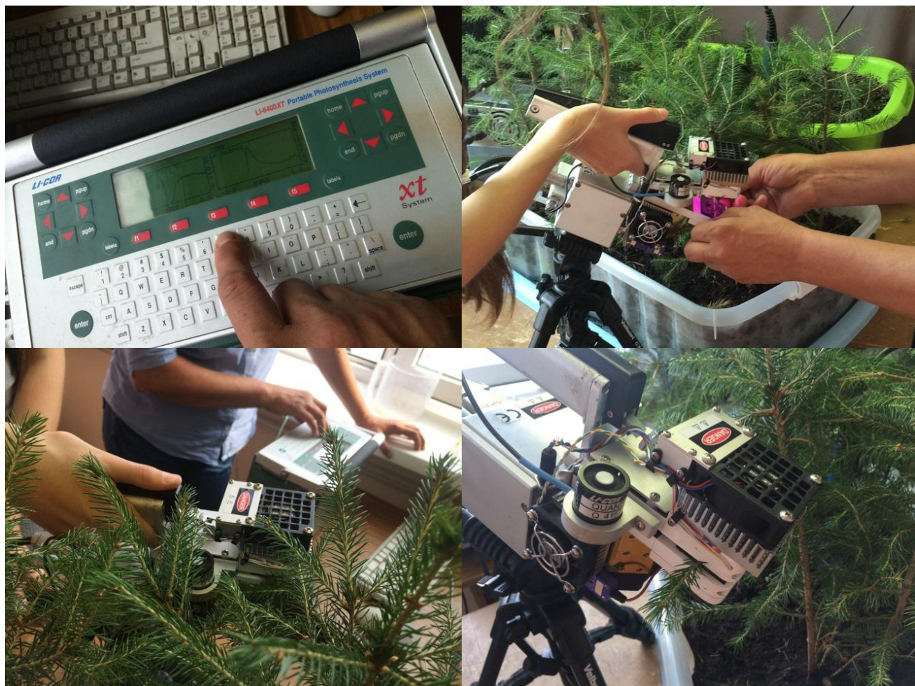
Рисунок 3.2. Измерение \text{CO}_2 -газообмена и транспирации хвои с помощью инфракрасного газоанализатора Li-6400XT
