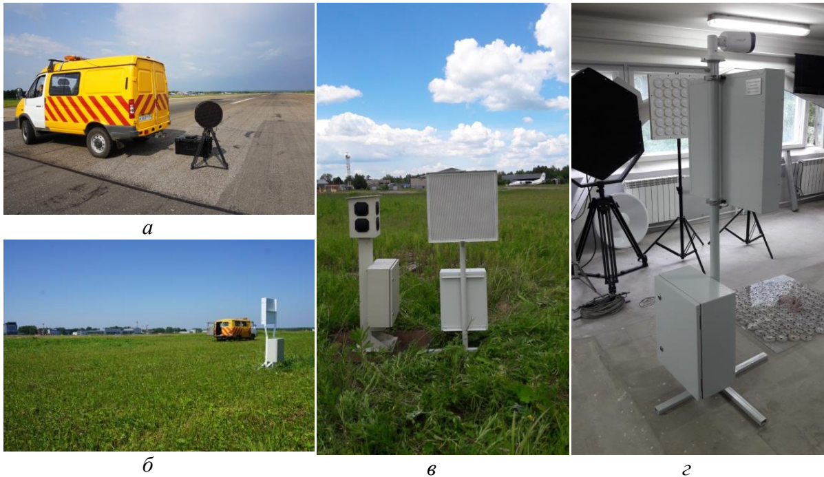
Рисунок 1. Акустический излучатель на 21-элементной антенной решетке (а), биоакустическая установка на 25-элементной антенной решетке (б), биоакустические установки (в) компании «Два крыла» (слева) и на 25-элементной антенной решетке в аэропорту г. Томска, излучатели на антенных решетках и биоакустическая установка с видеокамерой (справа, г).
