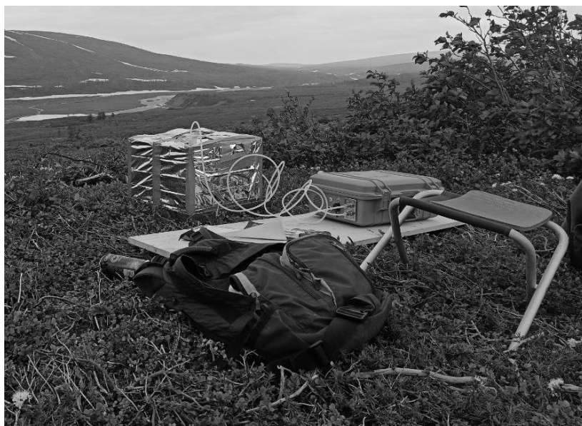
Рисунок 2. Измерение УПМ статической тёмной камерой.
